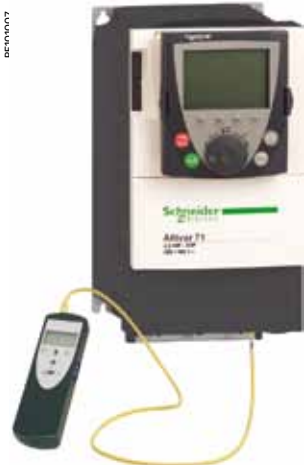
通过连接至ATV 71变频器的Multi-Loader工具进行配置
